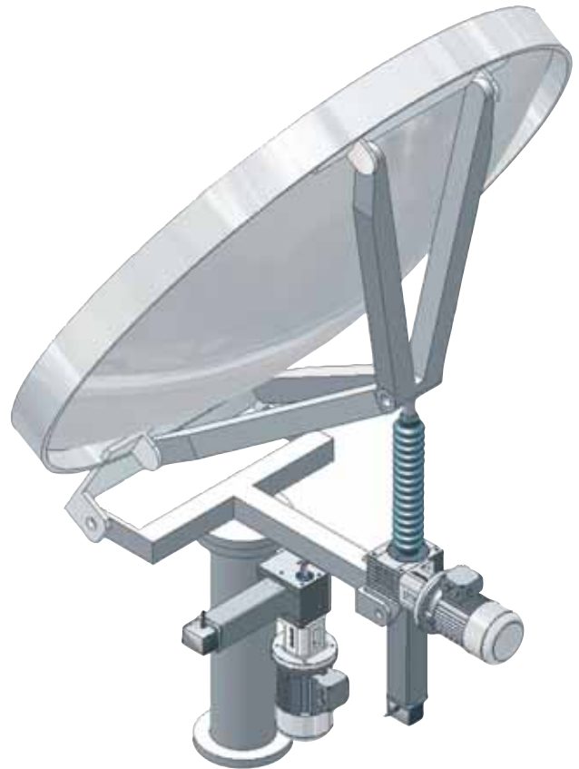
Parabolantenne D = 3,3 m, beide Achsen – Azimuth + Elevation – je 50 kN, Verstellweg pro Bewegung 0,02 - 0,05 mm; die Anlagen sind im Freien an einer Meeresküste installiert.
